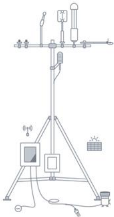
5. attēls. Eddi kovariances sistēma siltumnīcefekta gāzu novērtēšanai ekosistēmas līmenī. Foto: https://www.licor.com/env/products/eddy_covariance/
