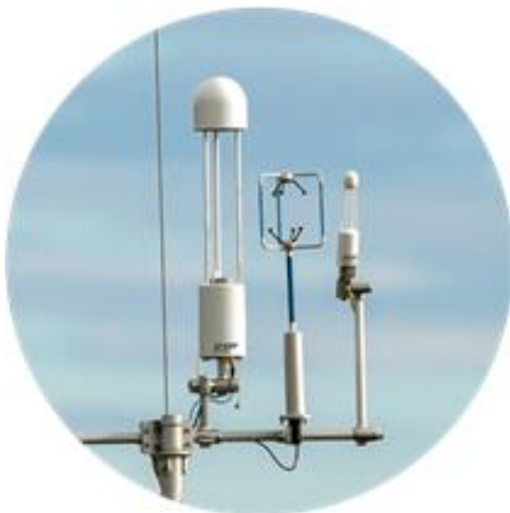
5. attēls. Eddi kovariances sistēma siltumnīcefekta gāzu novērtēšanai ekosistēmas līmenī. Foto: https://www.licor.com/env/products/eddy_covariance/
